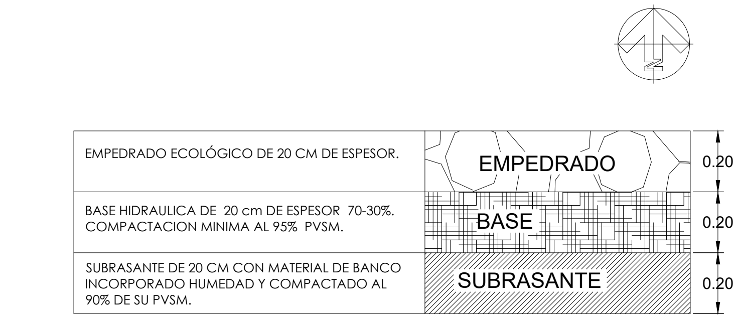
2 Conformación de Empedrado ESCALA: S/E
